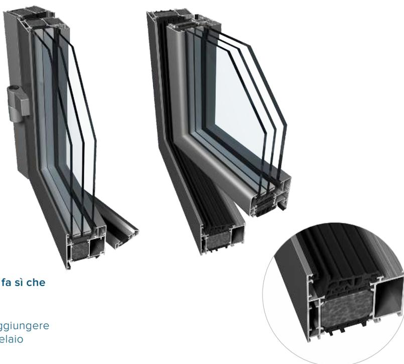
Nella versione HI l'inserimento di aero-gel nel profilo fa sì che il valore  $U_f$  diminuisca da 1,1 a 0,9  $W/m^2K$ .
